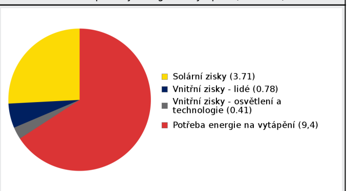
Bilance potřeby energie na vytápění (MWh/rok)
